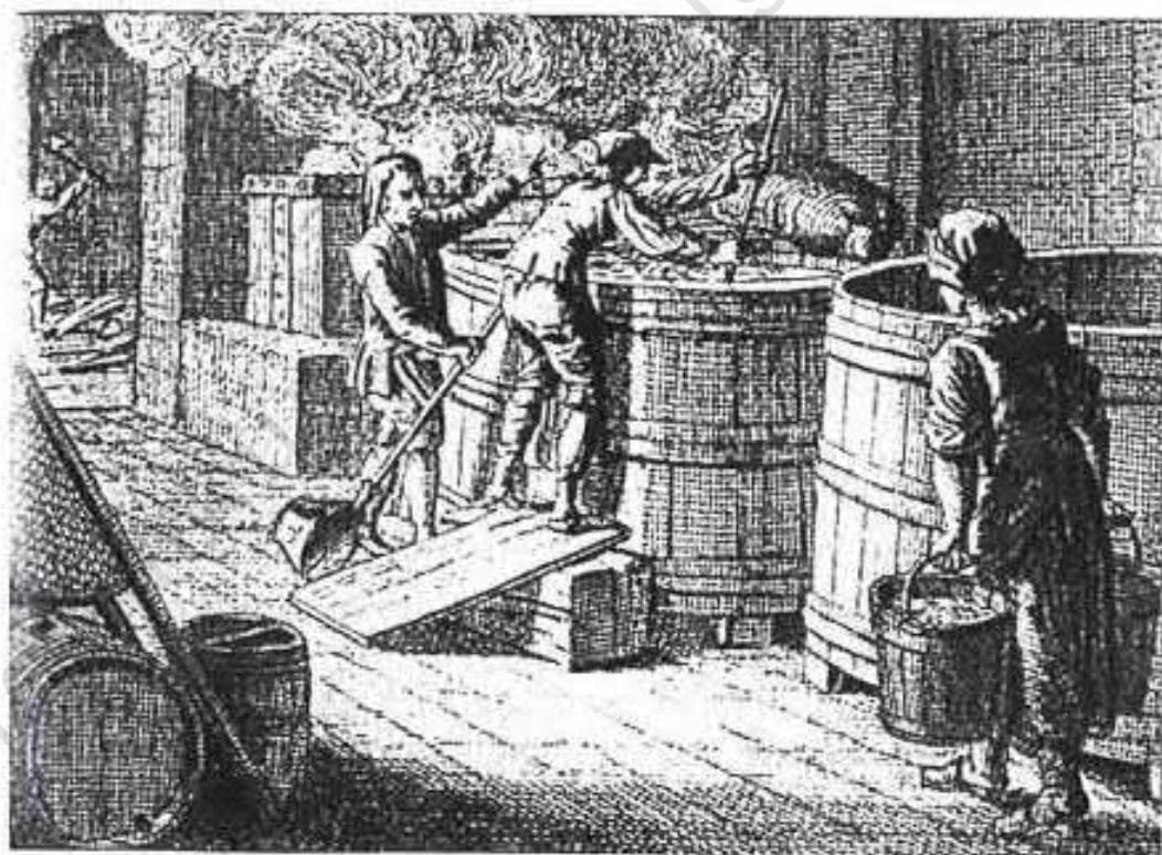
Bierbrouwerij uit de zeventiende eeuw. De vrouw brengt gemalen mout, dit wordt met warm water in de beslag- of roerkuip gestort. Het moutextract wordt onder de kuip afgetapt en in een vierkante bierketel gestookt met hop.
